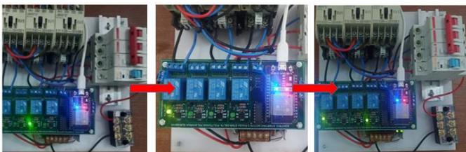
Gambar 25. Pengujian Star Delta
