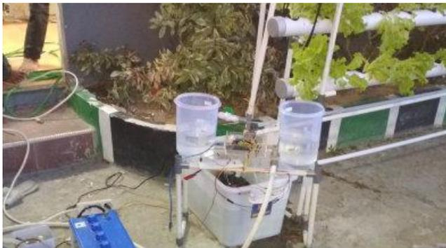
Gambar 6. Pengujian dengan menggunakan tanaman (Sayur) serta otomatisasi nutrisi dengan sumber energi dari panel surya.
