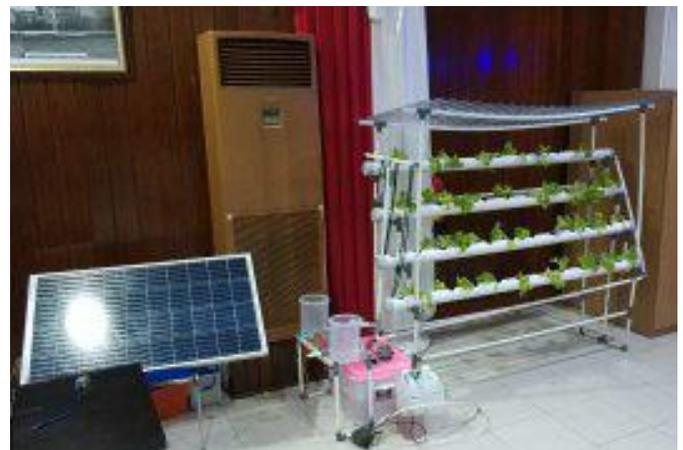
Gambar 9. Tanaman Hidroponik dengan kontrol otomatis menggunakan sumber energi matahari (panel surya).
