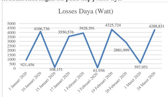
Gambar 8. Losses daya di penghantar netral.
