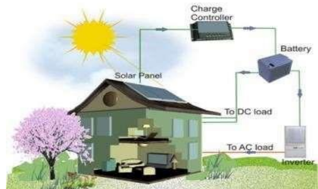
Gbr 1.2 Sistem OFF GRID (pt. bina lintas usaha ekonomi, 2018)
