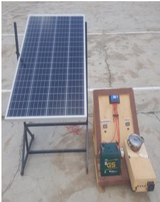
Gambar 6. Kompor listrik induksi yang menggunakan panel surya sebagai sumber energi listrik
