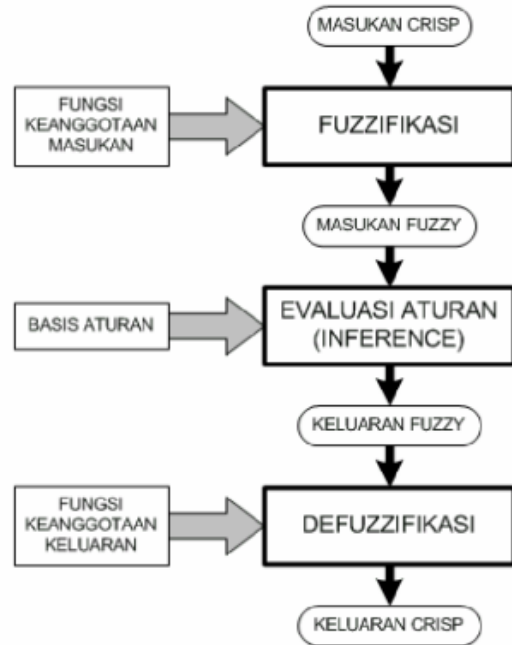
Gambar 4. Struktur Dasar Pengendali Fuzzy
