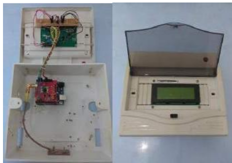
Gambar. 4 Bagian dalam dan tampilan luar bagian penerima
