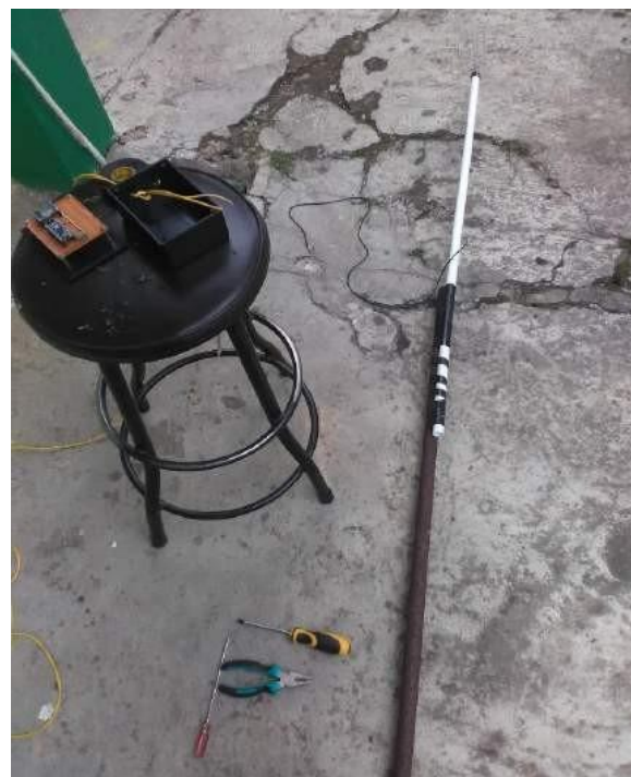
Gambar. 2 Rangkaian Arduino Nano, pemancar LoRa, dan antenna sebelum dipasang.
