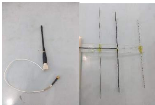
Gambar. 5 Antena rubber duck dan Yagi 3 elemen yang akan dipasang pada bagian penerima.
