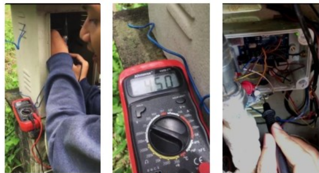
Gambar 5. Proses pengujian tegangan suplai modul GSM
