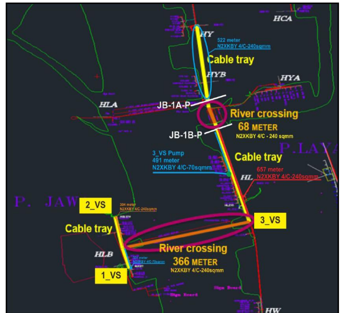
Gambar. 3 Rancangan rute instalasi kabel PCP
