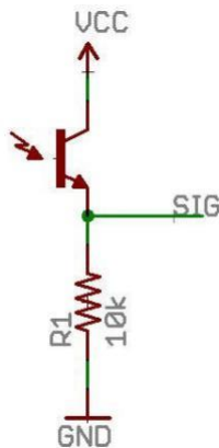
Gambar 2 Rangkaian sensor cahaya TEMT6000
