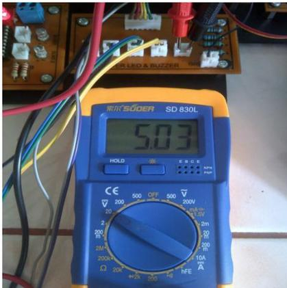
Gambar 17 Tegangan Output Pada LED
