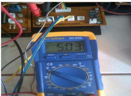
Gambar 18 Tegangan Output Pada Buzzer **Pengujian Minimum System**
