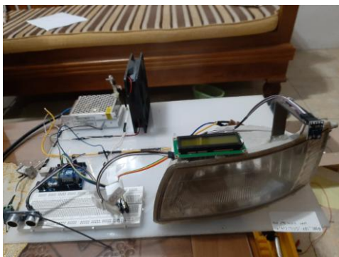
Gambar 4.1 Implementasi Alat Pengontrol Kecerahan lampu utama
