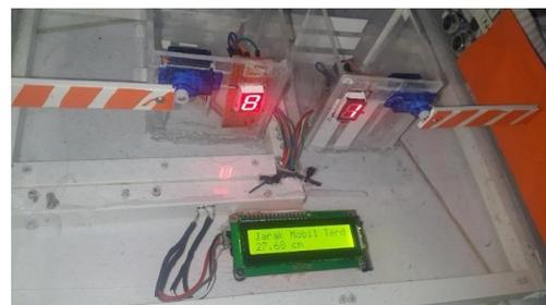
Gambar 3. Prototipe sistem parkir
